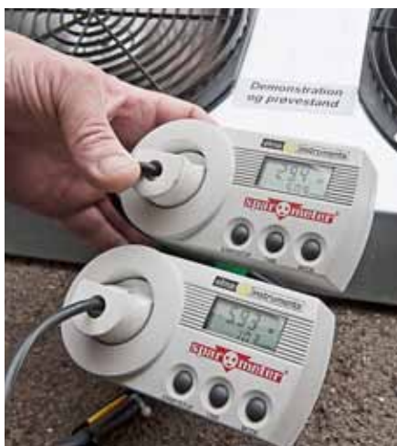
En måling af energiforbrug for en Q- og iQ-motor afslører en forskel på 80%.
